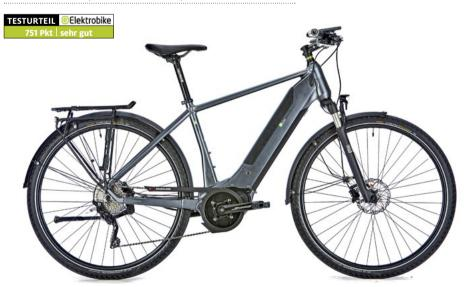
Premiere: Am E-Bike Manufaktur 13Zehn stellt sich erstmals der neue 48V-Motor von Continental dem Elektrobike-Test, allerdings nicht in der Revolution-Version mit integriertem Automatikgetriebe. Der verbaute "einfache" Prime-Antrieb überzeugt mit zügiger und harmonischer Unterstützung, wirkt im Anstieg aber einen Hauch
