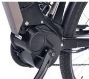
**Neue Entwicklung: Der Continental-Mittelmotor 48V Prime unterstützt am EBM.**
